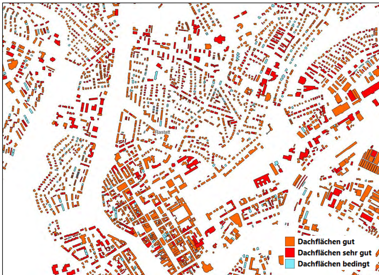
Abbildung 24: Potenzialkarte „Photovoltaik – dezentral“ auf Gebäudeebene (Einstufung nach Energieatlas BW)
